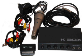
Die K-Box von Sunfly: Mit Zubehör ist sie Mischpult mit Mikro, Tone und Echo lassen sich einstellen, an Verstärker und Fernseher anschließbar
